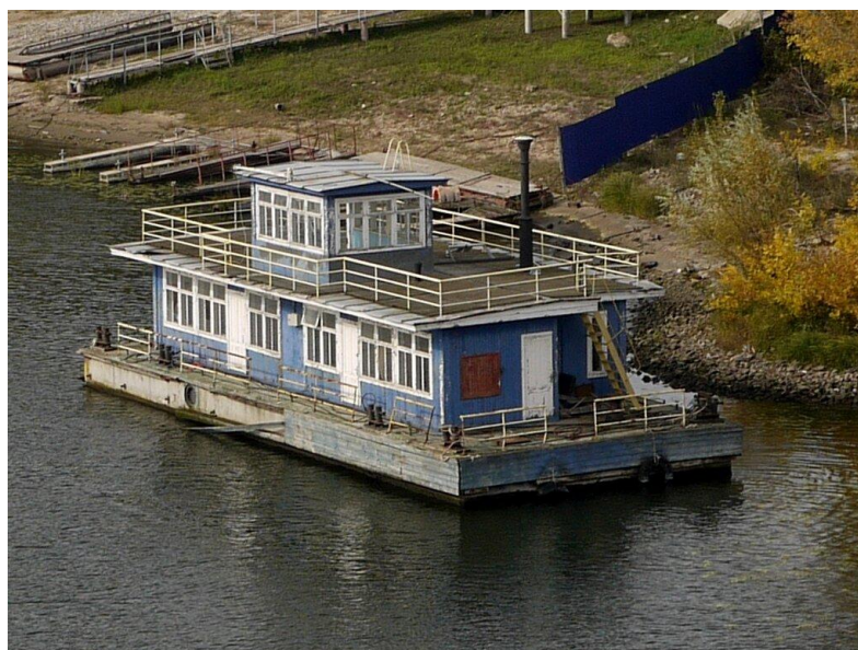
Рис. 3. Дебаркадер из железобетона [6].
