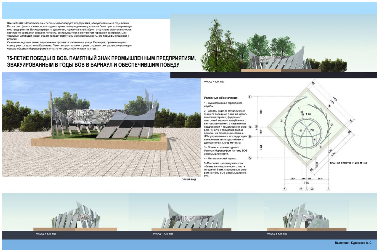
Ил. 5. Эскизный проект под девизом ТФУ 319, автор — выпускник Института архитектуры и дизайна АлтГТУ Алексей Сергеевич Куранков. Композицию монумента составляют два полукруга в плане, которые образованы наклонными стеллами, с цилиндром на опорах внутри. Стеллы символизируют предприятия, эвакуированные в годы войны. Ритм стелл, их нарастающая высота и наклоны, создают стремительную динамику, которая была присуща перемещению и разворачиванию предприятий. Центральный цилиндрический объем придает памятнику монументальность, его барельефы отсылают к истории
