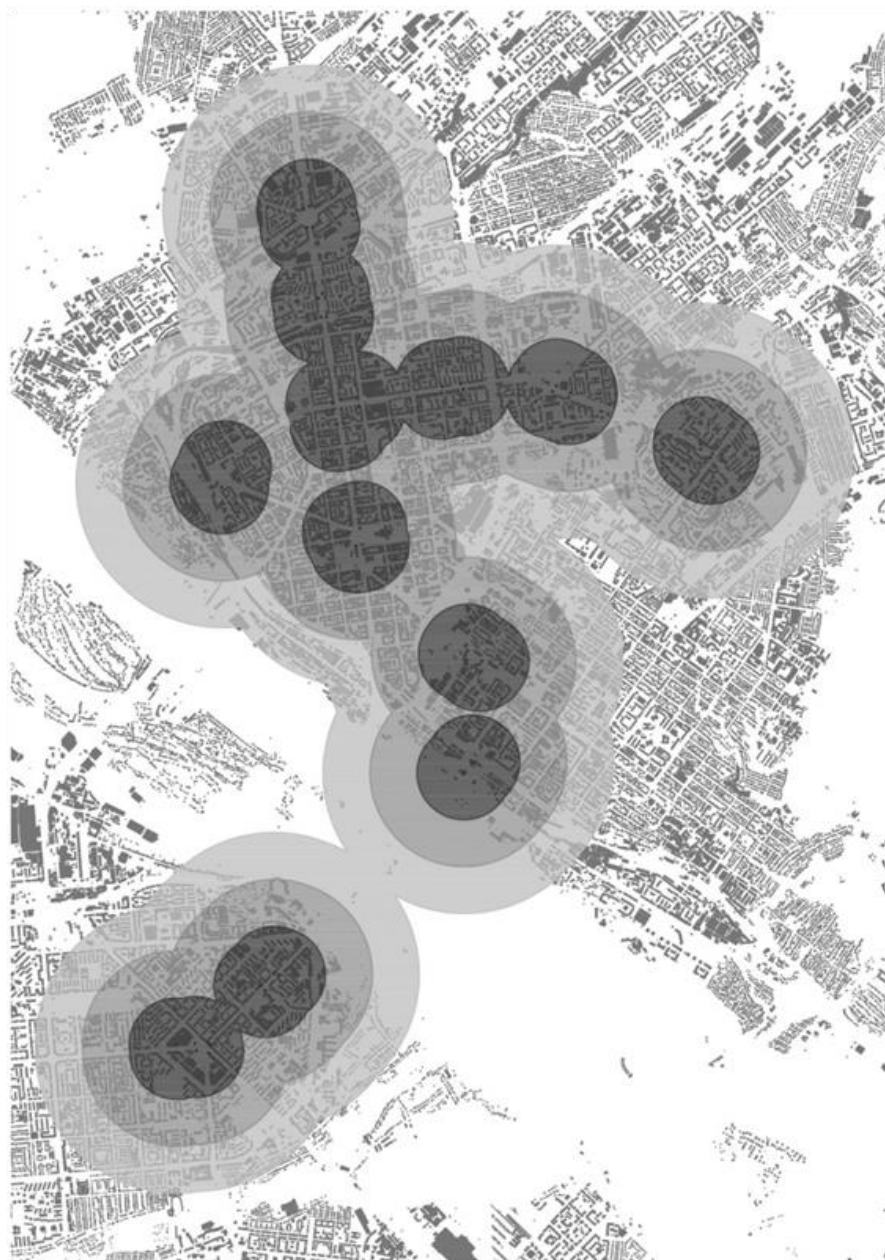
Рис. 3. Зона влияния метро по радиусам шаговой доступности при средней скорости пешеходов 2,9 км/ч: 480 м – темный; 960 – серый; 1440 – светлый
