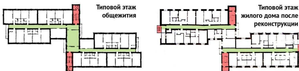
Рис. 2. Реконструкция общежития на ул. Сибиряков-Гвардейцев, 64/1 под жилой дом. 1997 г. [4]
